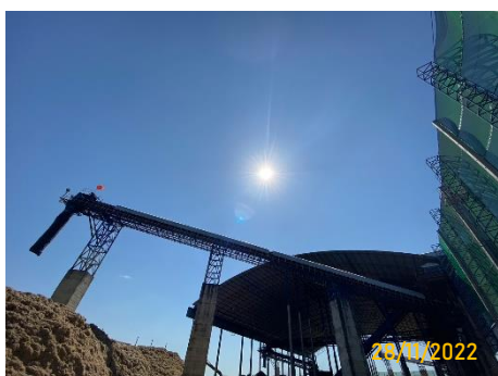
ภาพที่ 2 สายพานลำเลียงระบบปิดครอบ
